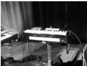
Cet instrument, inventé en 1947 par Constant Martin, l'un des plus brillants inventeurs français dans le domaine des orgues électroniques. Le clavioline est un instrument électronique monodique portable, constitué d'un générateur de sons fondé sur la transposition d'octaves : à partir d'un seul oscillateur, on obtient un potentiel de 5 octaves.
